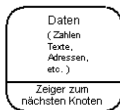
Abbildung 1.1: Aufbau eines Knotens (Node)
